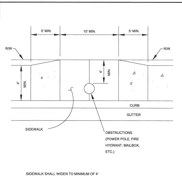
SIDEWALK SHALL WIDEN TO MINIMUM OF 4' CLEARANCE FOR A MINIMUM LENGTH OF 10'. MINIMUM TRANSITION LENGTH SHALL BE 5'.
